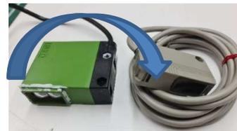
Le kit M0620MS a été développé pour aider à installer la nouvelle cellule photoélectrique dans les contrôleurs Gascoigne Melotte Tandem existants. Il peut également être utilisé lors du montage de composants sur un nouveau boîtier. La cellule photoélectrique d'origine était verte et plus grande, donc une certaine adaptation est nécessaire pour passer à la version grise plus petite.
